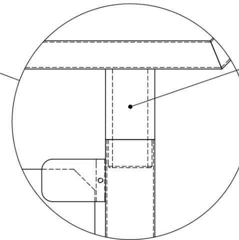
Sujeción cubierta mediante manguito que se introduce en el pilar y se condensa con un tornillo
